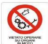
Nicht in drehende Teile greifen. Keine Wartungsarbeiten bei laufender Maschine.
